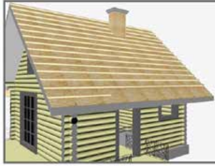
5. 5x5 cm'lik çıtalar OSB plakalarına yatay olarak 37 cm aralıklarla çivi ile monte edilir.
