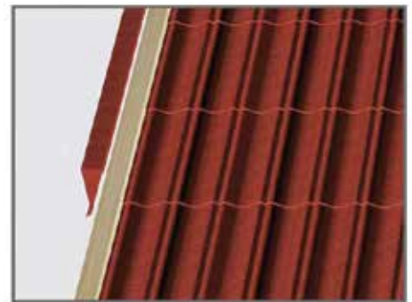
12. Yan saçaklara sırtlar yerleştirilir.
