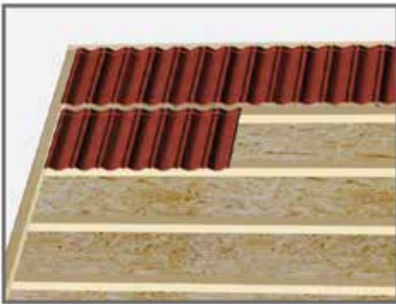
10. İkinci sıradaki metal kiremit birinci sıradaki metal kiremitin altına yerleştirilir.
