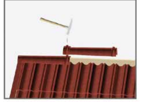
15. Zirvedeki çıtaların üzeri yuvarlak mahya ile diğeri üst üste gelecek şekilde monte edilir.
