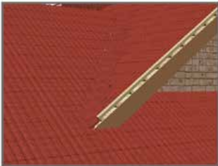
22. Vadi dere ve metal kiremitin monte edilmiş halidir.
