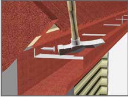
19. Gizli kelepçeler 50 cm'lik aralıklarla çatının alın kısmına çakılır.
